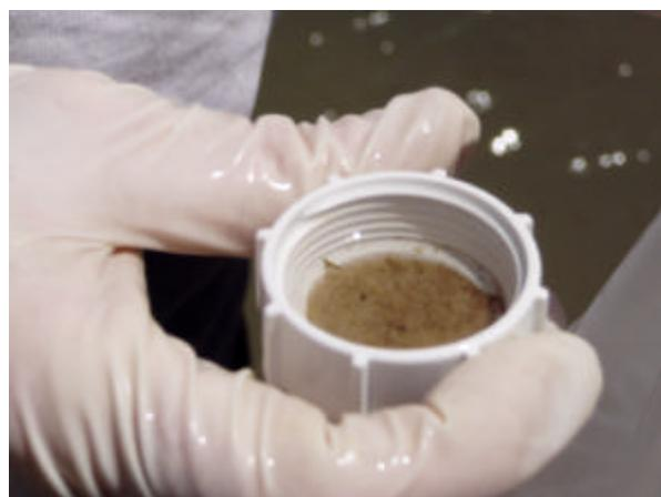
**Figura 2.** Filtro que retiene la muestra que posteriormente se analiza
