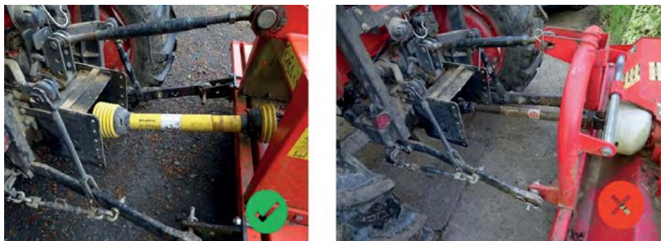
Foto 53 Cardan con protección y sin protección
