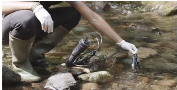
2. ilustrazioa. In situ neurketa zunda multiparametrikorekin.
