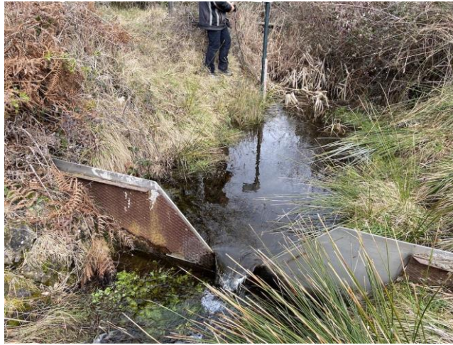
Figura 6 Aspecto de la estación de aforo Arreo Salida (Vertedero Triangular 90°).
