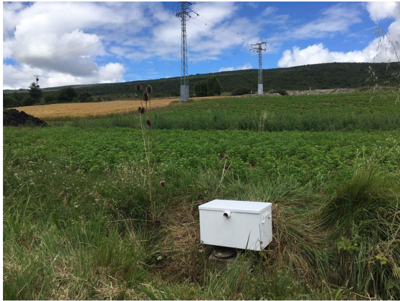
Figura 4 Estación de control piezométrico SP04-Sondeo Subijana-2.
