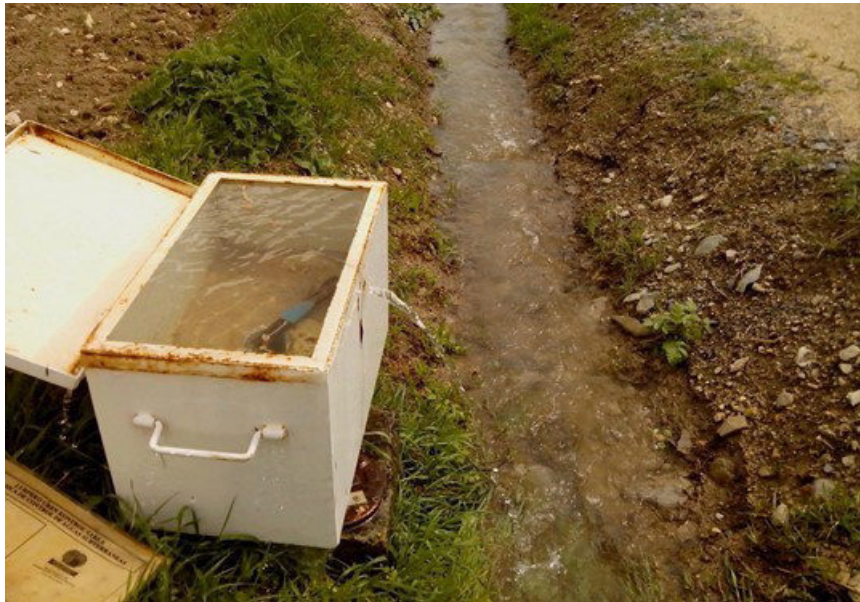
Figura 2 Estación de control piezométrico SP04-Piezómetro Subijana-2. Surgente (12/04/2018)
