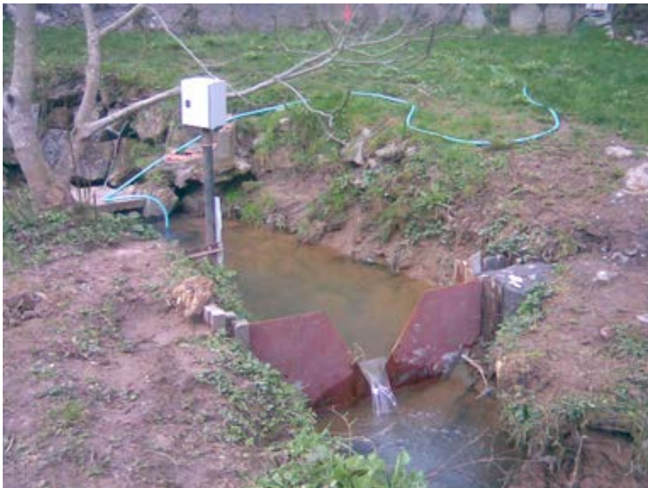
7.1. irudia - Angela iturburuko aforo-estazioa (60º hiruki formako emaribidea)
