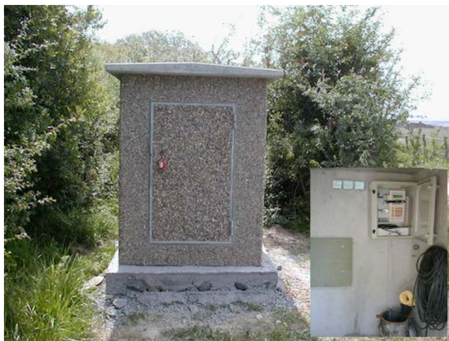
2.2.irudia- Kontrol piezometrikorako estazioa (SP13-Salburua-1 zundaketa)
