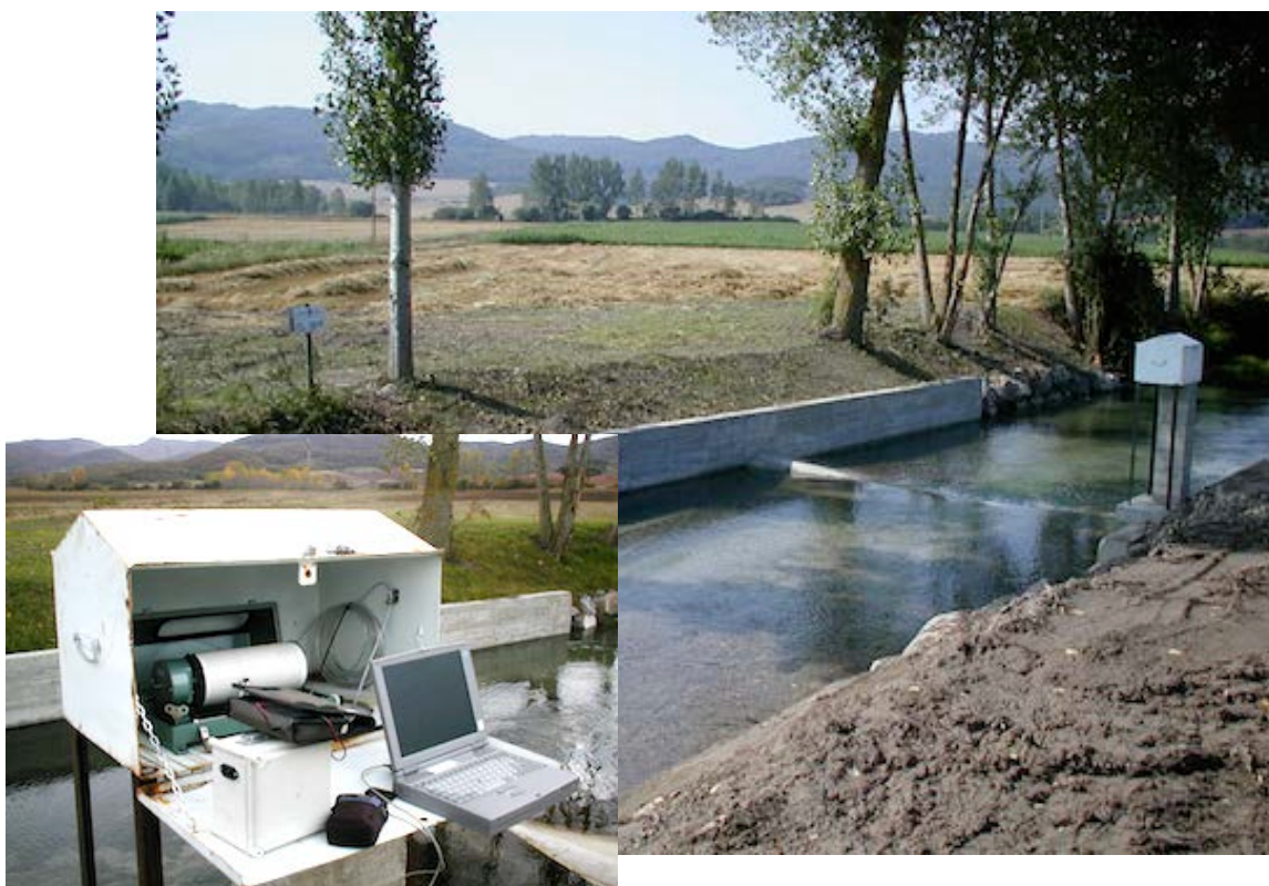
2.1.irudia- Aforo-estazioa.. Aldaturiko Crupm tipoko isuribideduna (SA01-Urizaharra iturburua)
