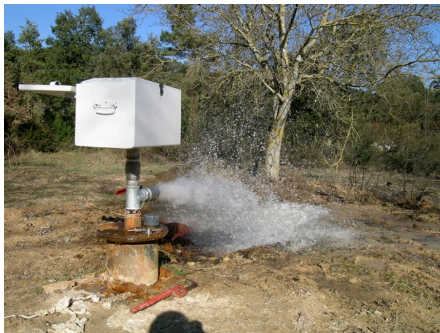
Fig. 2.2.- Estación de control piezométrico SP16-Sondeo ANGOSTO (106-03) (Sondeo surgente).
