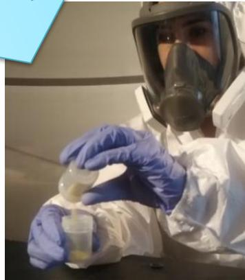
**Trasvase** de 5 g de nanopartículas: **NP SiO<sub>2</sub> comercial de 10 nm**, mezcladas con un 10% en masa de **NP fluorescentes Ru(phen)<sub>3</sub>@SiO<sub>2</sub>**
