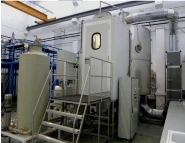
*Cámara de exposición de atmósfera controlada (13 m<sup>3</sup>) con sistema automático de limpieza integral (aire-agua)*
