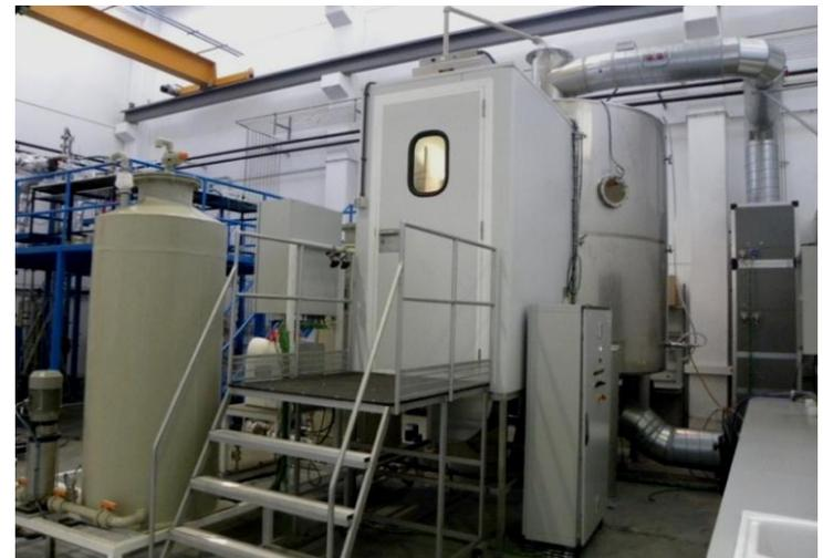
*Cámara de exposición de atmósfera controlada con sistema automático de limpieza integral (aire-agua)*
