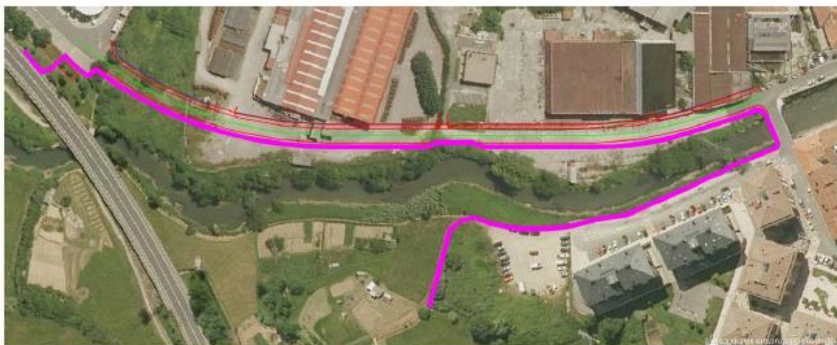
Figura 65. Muros propuestos de 1 m de altura
