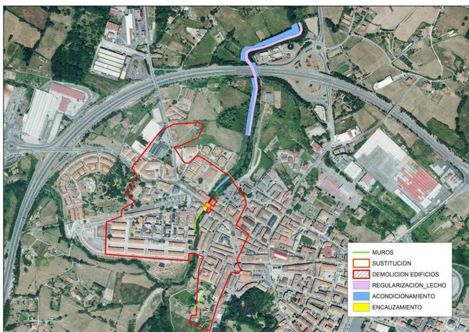
Figura 6. Actuaciones propuestas para la Fase 1. Opción B. ARPSI de Mungia. PGRI 1er ciclo
