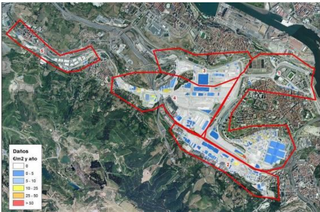
Figura 86 Ámbitos de actuación y daños en el ARPSI de Galindo.
