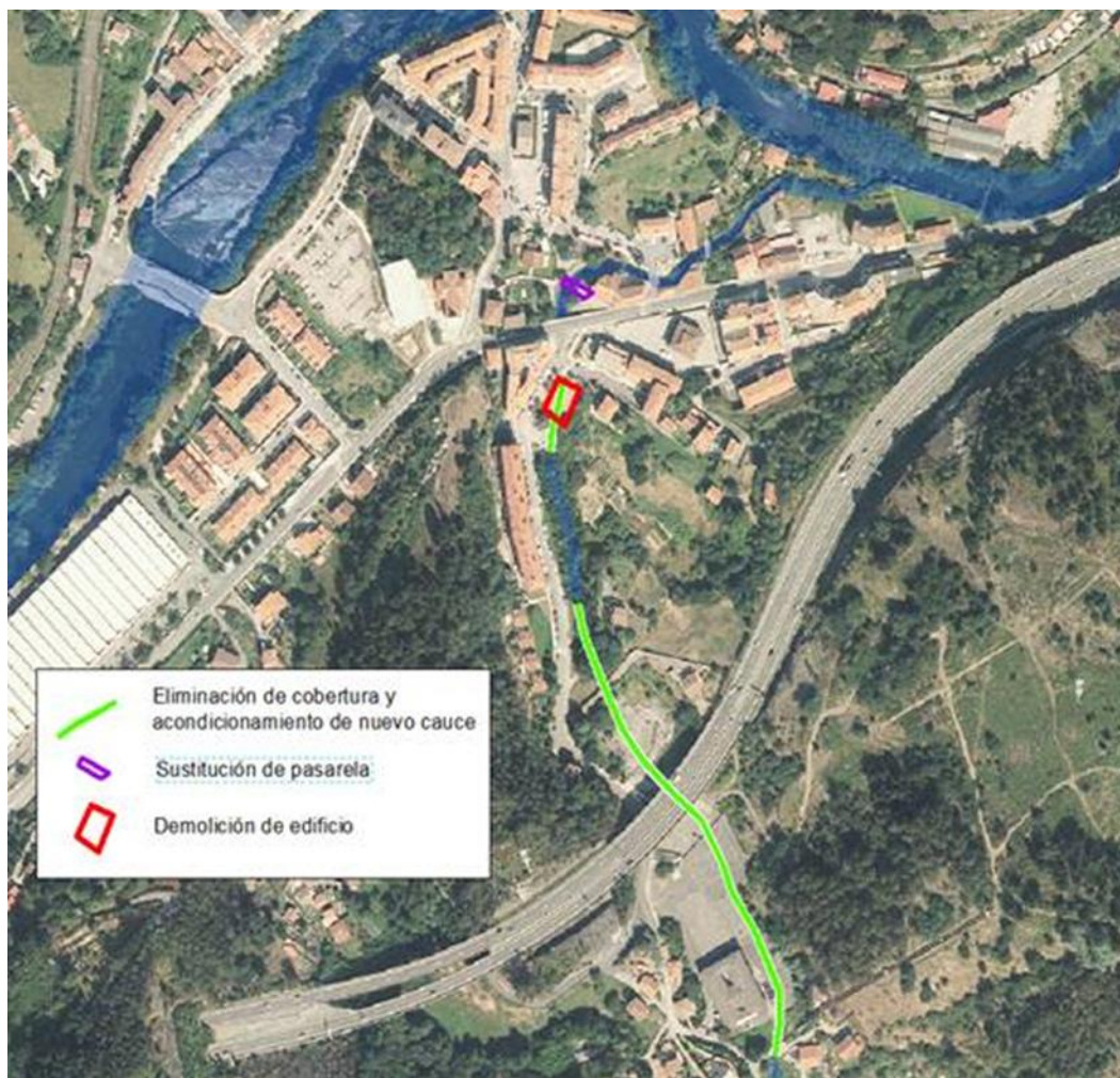
Figura 113 Ubicación en planta de actuaciones ARPSI Alonsotegi-2
