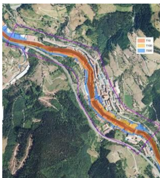
Figura 98 Zonas inundables actuales y delimitación de fases en el ARPSI de Soraluze.
