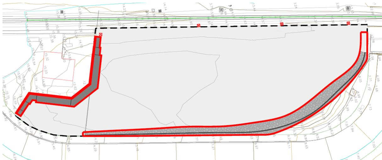
Figura 8. Planta de muros a ejecutar. Izquierda muro en ménsula de Hormigón Armado y en la parte inferior el muro de escollera.
