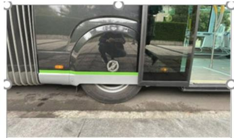
*Carenado en el paso de rueda para mejorar la aerodinámica y la eficiencia energética*
