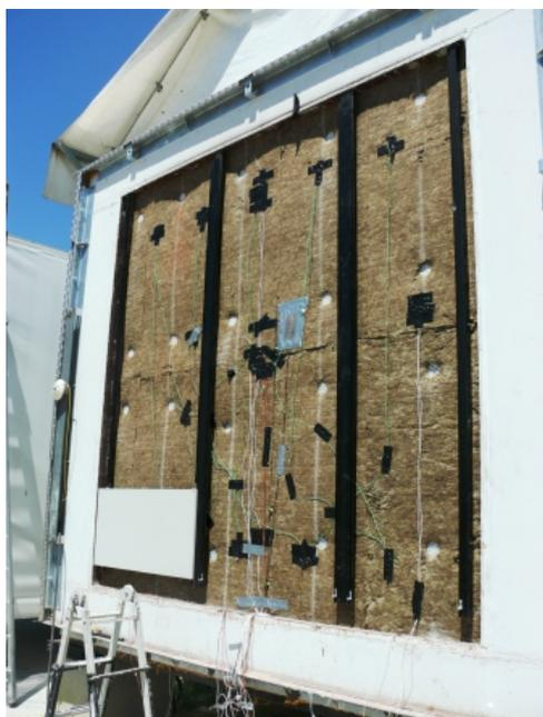
Colocación de sensores en capa aislante y del anclaje de la perfilaría para el aplacado
