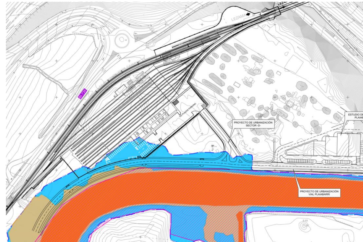
Figura 34: inundación original (azul), inundación en proyecto (rosa a rayas)
