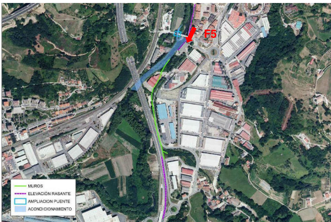
Figura 23.- Ubicación en planta de las actuaciones en el tramo entre Puente de Ergobia y Puente de Karabel y de las fotografías e imágenes posteriores
