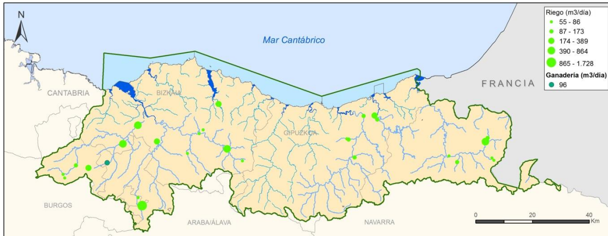
Figura 25 Extracciones superficiales para agricultura (riego) y ganadería con un volumen superior a 20.000 m³/año
