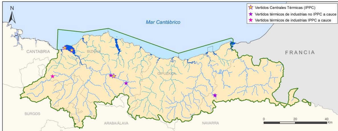
Figura 4 Vertidos térmicos procedentes de las aguas de refrigeración con un volumen superior a 100.000 m 3 /año, procedentes de centrales de generación de electricidad y de otro tipo de industrias clasificadas como industrias IPPC o no IPPC
