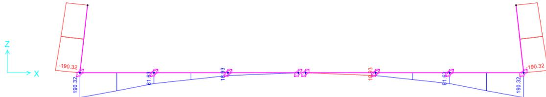
Momento flector de cálculo, en kNm, sobre la losa bajo la hipótesis de carga n°1 en ELS-3
