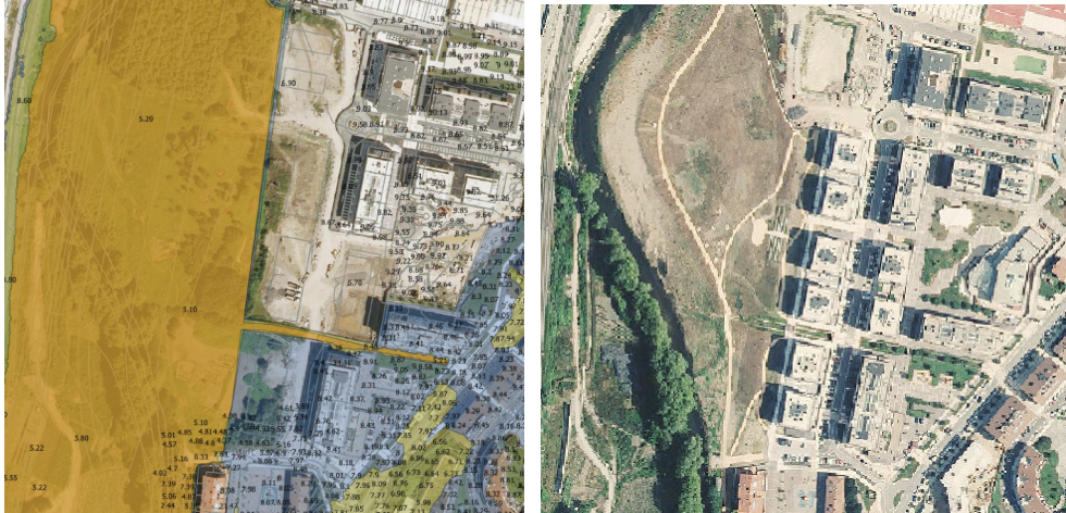
4. irudia. Astigarragako Udalak aurkeztutako arriskugarritasunaren ordezko topografia eta kartografia (ezkerrean) eta 2019ko aireko argazkia alderatzea, egun horretan egin baitziren eredu hidraulikoaren neurketa topografikoak.
