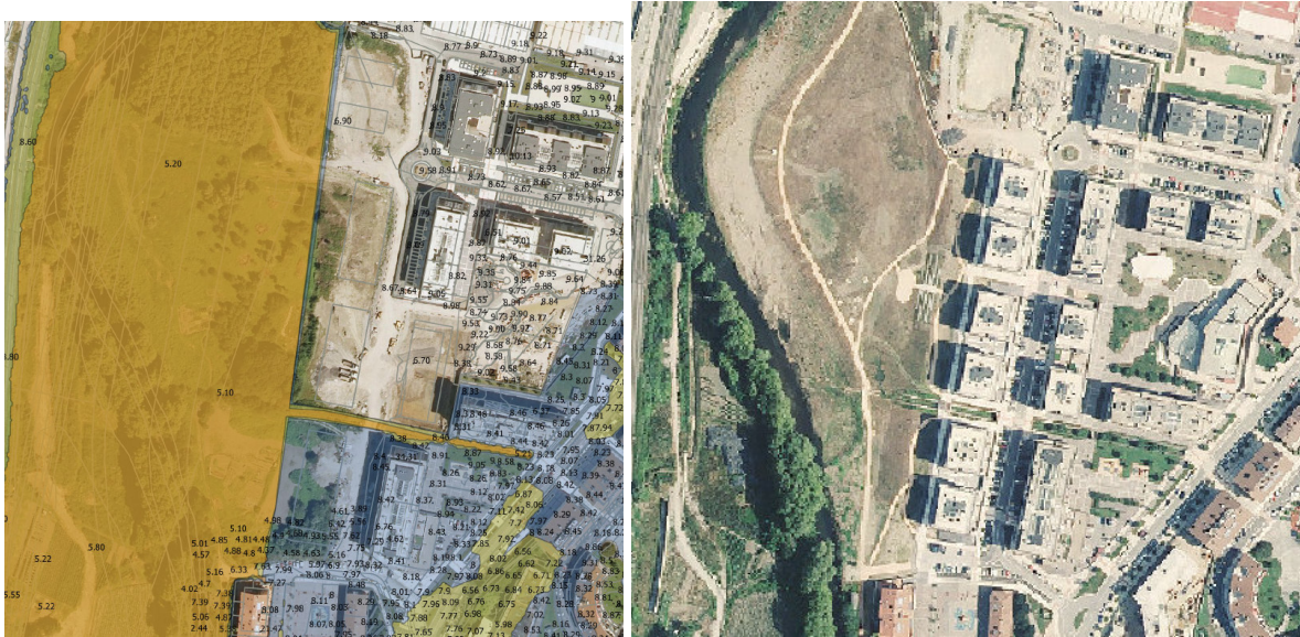
Figura 4. Comparación de la topografía y cartografía alternativa de peligrosidad presentada por el Ayuntamiento de Astigarraga (izquierda) y la fotografía aérea del año 2019, fecha en la que se hicieron las mediciones topográficas del modelo hidráulico.
