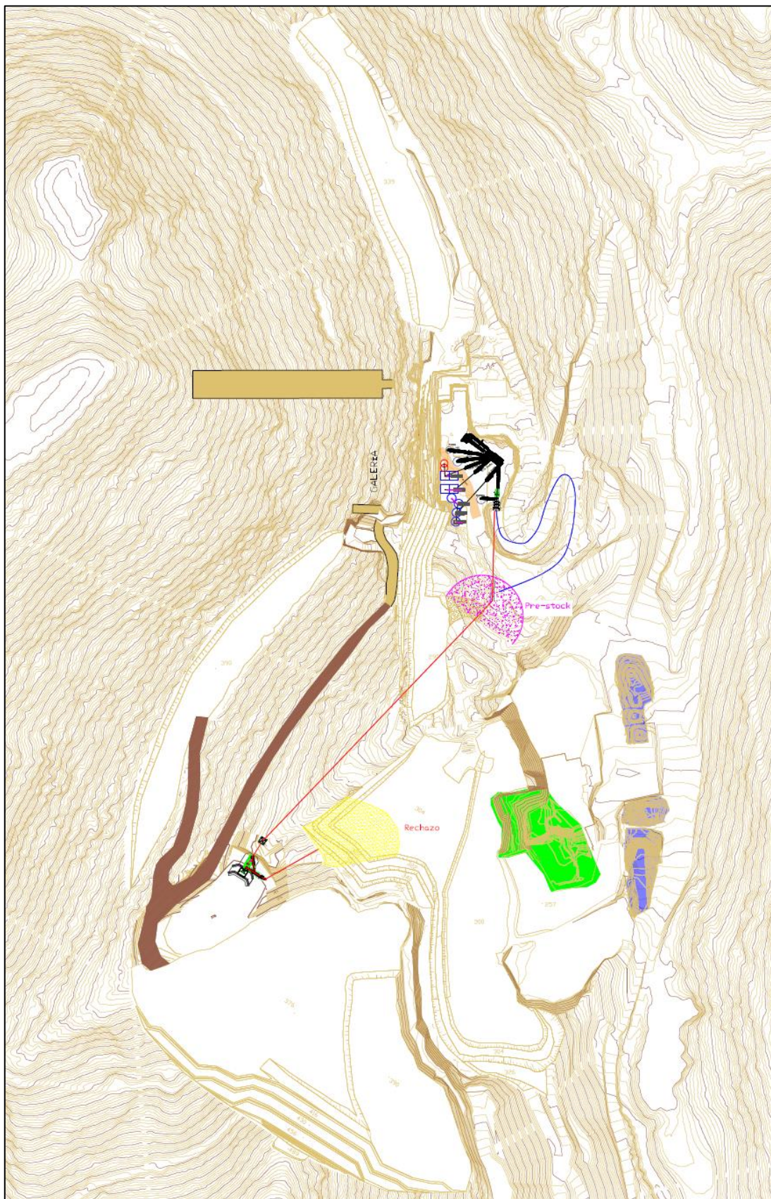
Figura 5.3.- Plano nº 6: Fase 4 del proyecto de explotación.
