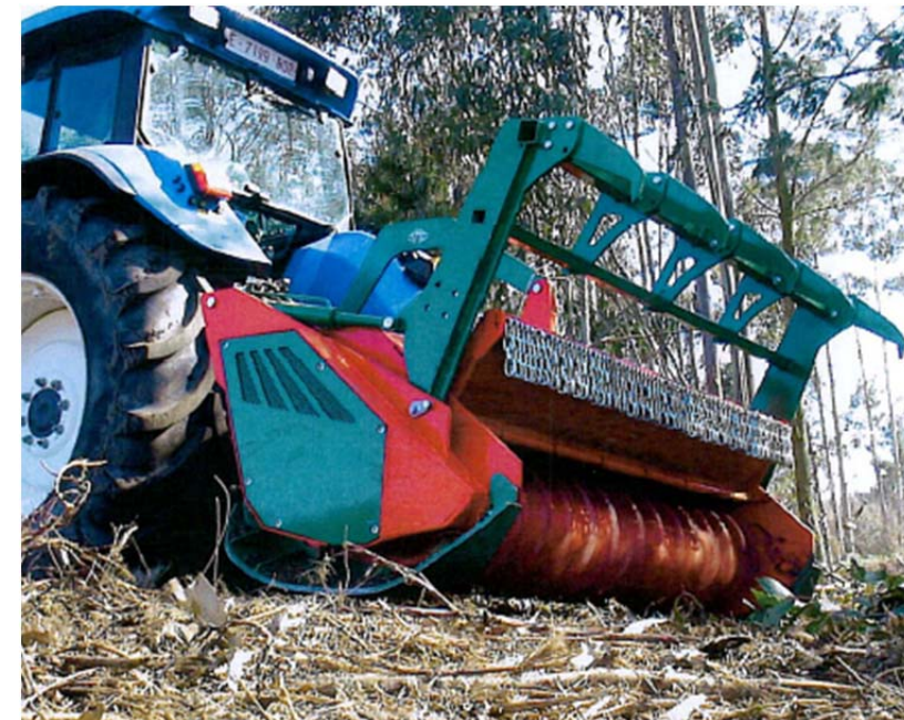
Trituradora forestal de martillos fijos implementada en tractor forestal llevando a cabo trabajos de desbroce
