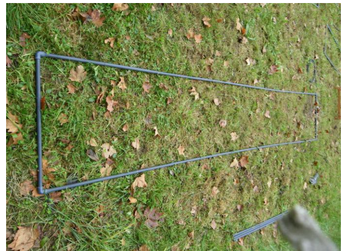
Foto 6. Detalle antena rectangular de toma (4x0,80 m)
