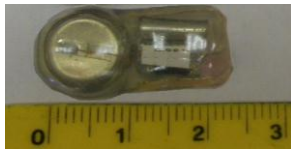
Foto 29. Radiotransmisor F1150 (ATS Inc.)
